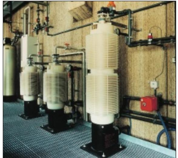
**Назначение:** Выносной теплообменник для охлаждения, нагрева и конденсации агрессивных сред. Производительность как конденсатора приблизительно до 500 м<sup>3</sup>/ч.
